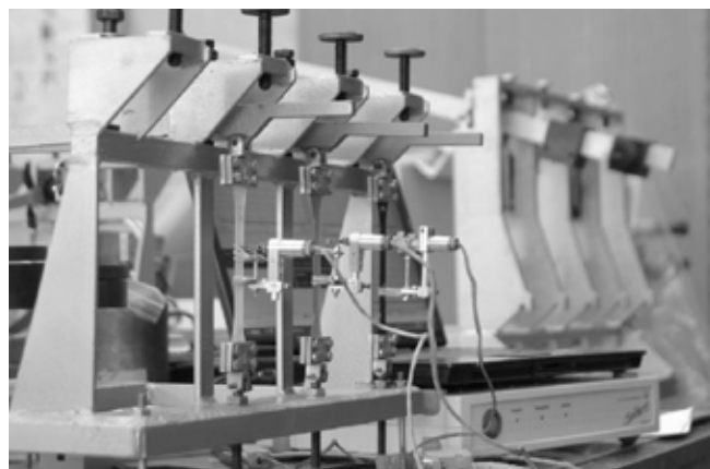
14. attēls. Šķūdes stends ar nanokompozītu paraugiem, kas tika noslogoti pie trim dažādiem sprieguma līmeņiem.
