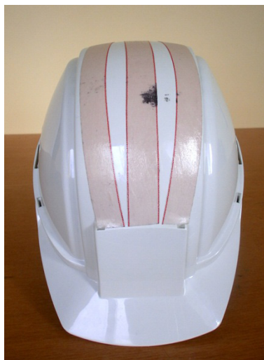
14.attēls. Celtnieku ķivere ar trim pielīmētām jūtīgām strēmēm. Tumšs plankums parādījās pēc 5 kg tērauda sijas gabala kritiena uz ķiveri no 0,5 m augstuma.
