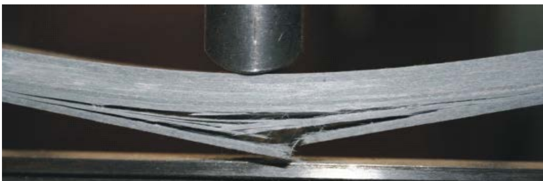
Att. 3.15. Parauga sagraušanas fotoattēls trīspunktu liecē
